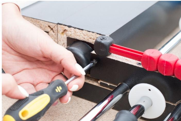
3.7. Устанавливаем ножки: извлекаем болты из пакета с крепежом и с помощью шестигранного ключа фиксируем ножки с помощью этих болтов. Каждая ножка имеет номер и соответствующий ей номер на углу стола. Необходимо соблюсти это соответствие при сборке. Поднимаем ножку вертикально, как показано на рисунке и фиксируем болт в ножку, после чего, затягиваем шестигранным ключом все необходимые болты.
